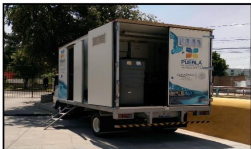
Figura 1. Estación de monitoreo móvil (foto izquierda) y fija (foto derecha) para la medición de parámetros de calidad del agua en río Atoyac, Puebla. Fuente: SDRSOT
